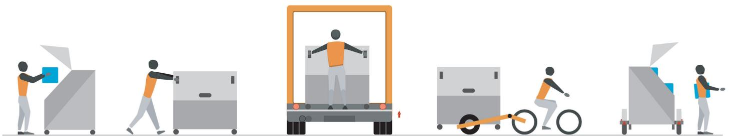
BicyLift, eine von FlexiModal patentierte und entwickelte Palette von Logistiklösungen
